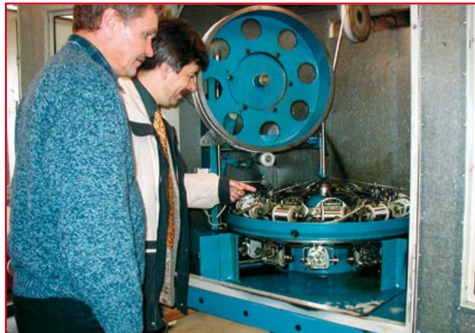
Fot.1. Dr. Hansjörg Widler i Marek Trajdos przy maszynie do wykonywania oplotu ekranowego w zakładzie produkcyjnym w Windsbach, gdzie wytwarzanych jest ok.15.000 typów kabli.
